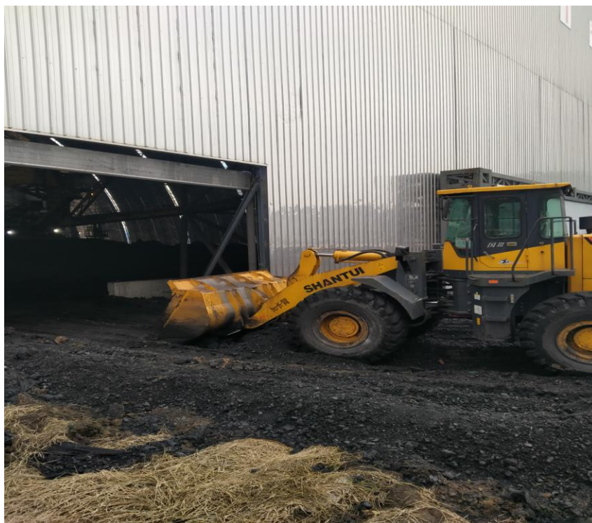
图 5 煤泥晾晒施工作业
