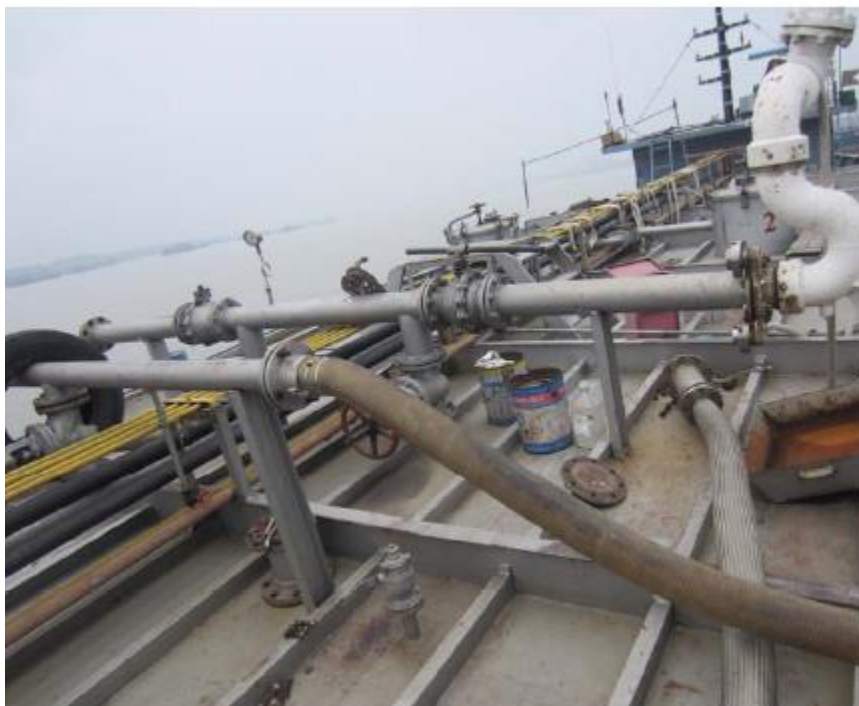
船舶船岸气相接口与软管连接
