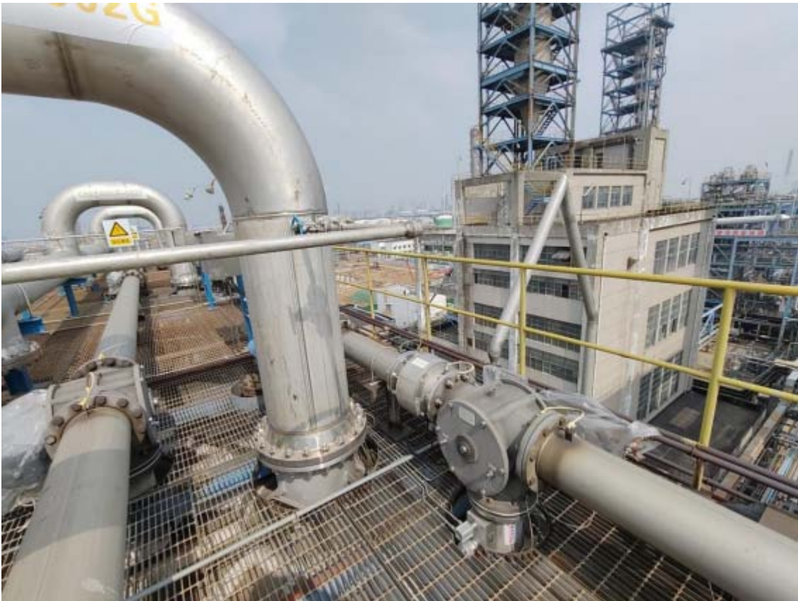
图 9 F502G 料仓静电监测消除系统仪表箱
